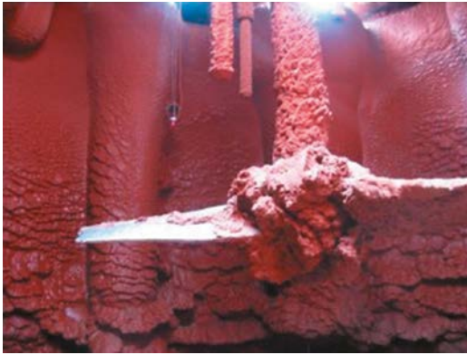
Рис. 2. Фотография мешалки и внутренних устройств, заросших частицами
