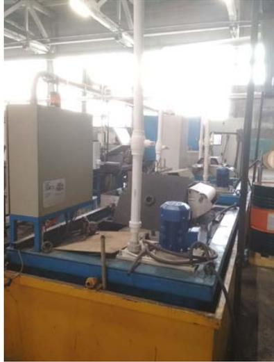
*Насосы, обеспечивающие подачу СОЖ являются неотъемлемой частью токарных, фрезерных и других металлообрабатывающих станков. Импортное оборудование оснащается дорогостоящими стальными или чугунными полупогружными насосами.*
