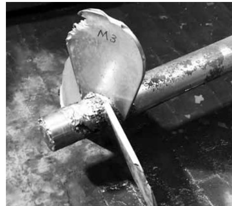
Рис. 7. Износ перемешивающего устройства при работе в суспензии
