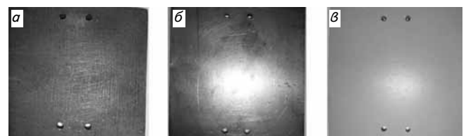
Рис. 4. Образцы, испытываемые на гидроабразивной коррозионно-активной среде: а — сталь конструкционная углеродистая, б — нержавеющая сталь, в — композитный материал
