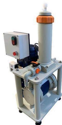
**Мы предлагаем практичное решение - установку фильтрации, оснащенную электрическим самовсасывающим мембранным насосом серии "Astra" с фильтровальной камерой CFMINI и блоком контроля давления, который автоматически отключает насос при загрязнении фильтрующего элемента.**
