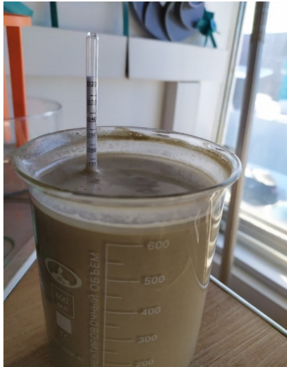
Рис.9. Определение плотности суспензии в лабораторных условиях
