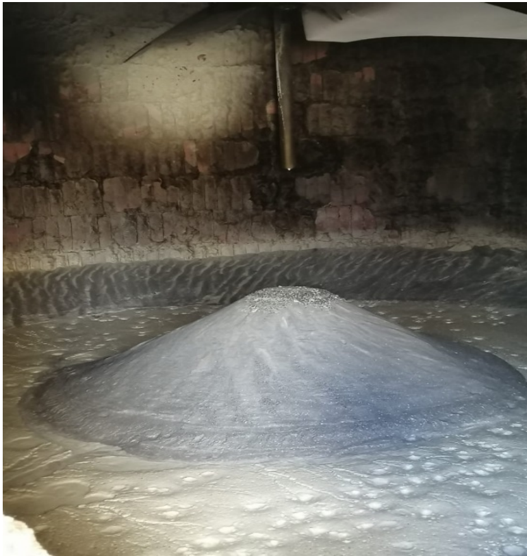
Рис.5. Образование отложений извести под лопастной мешалкой
