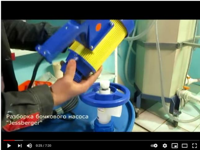
Ролик демонстрирует легкость разборки и сборки бочкового насоса и может служить наглядным пособием для обслуживания и замены запасных частей.
